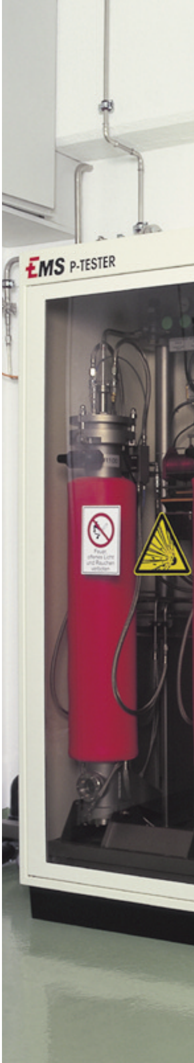
Permeabilität Benzindurchlässigkeit verschiedener Rohrtypen (8x1 mm)
